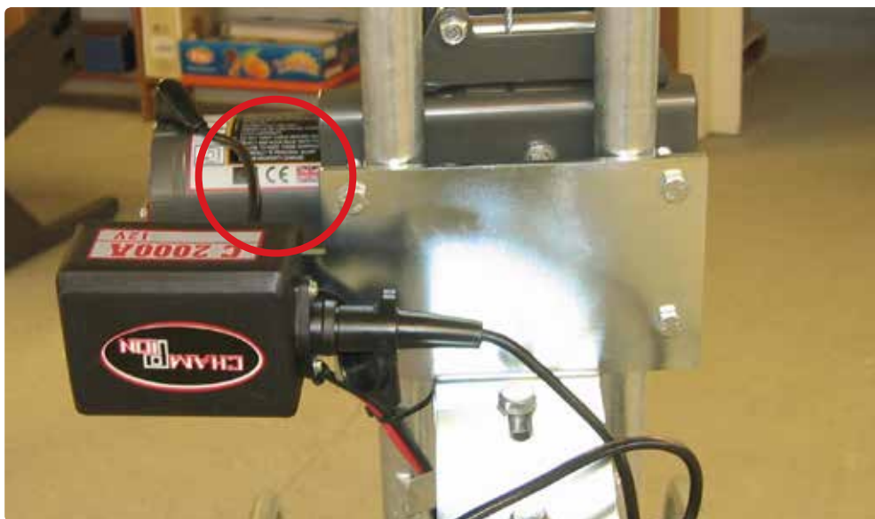
Figur 11. Her ses el-spillet på en sådan måde, at CE-mærket (fremhævet i den røde ring) er synligt. Foto: Brocken.
