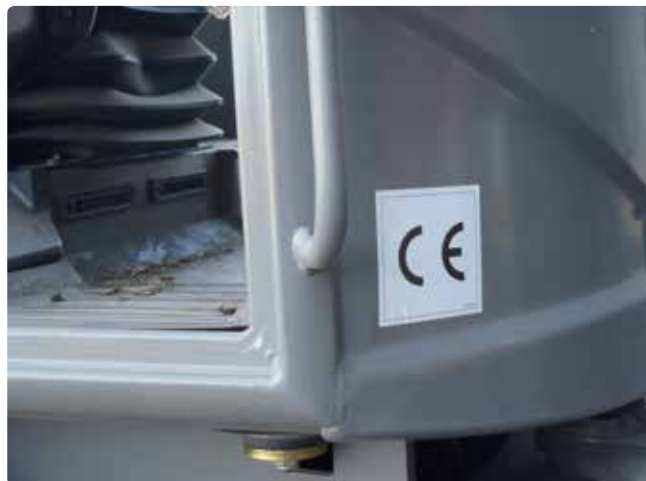
Figur 5. CE-mærke på frontlæssers førerhus.
